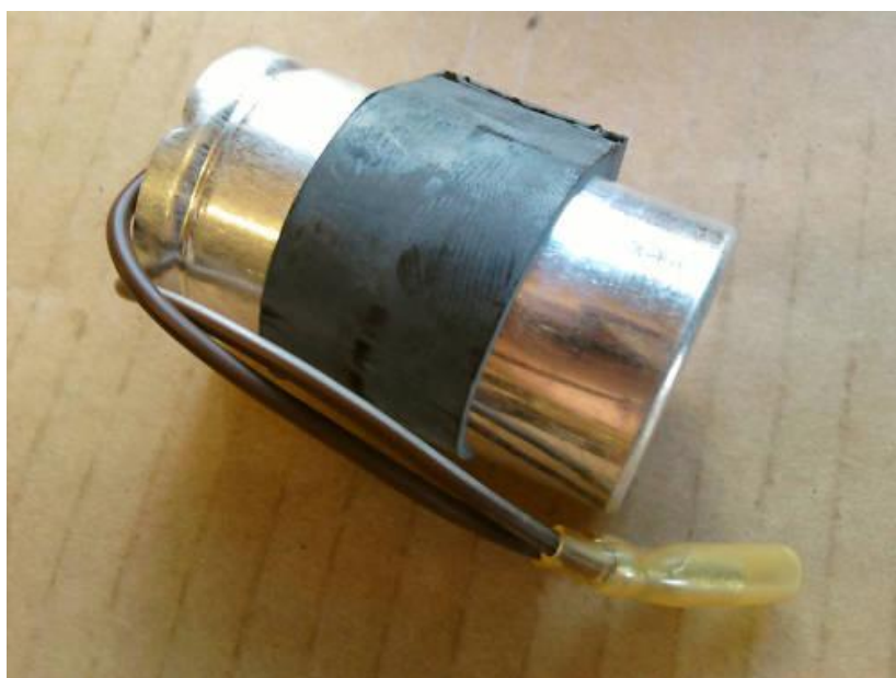
Blinkysrelæ 1977-79, originalt. Bemærk ledningsfarver (brun og brun/hvid), samt gennemsigtig gummiafdækning på stik.
