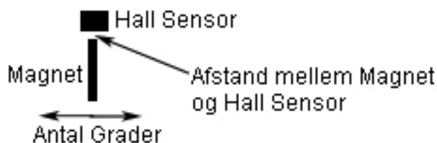
Figur 50 Test Af Hall Sensor
