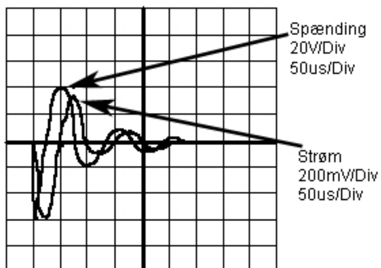
Figur 71 Strøm/Spænding i primær spole ved gnist
